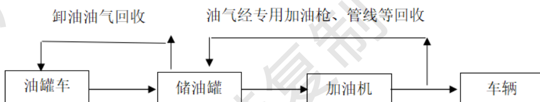
图 2-2 加油站工艺流程图
