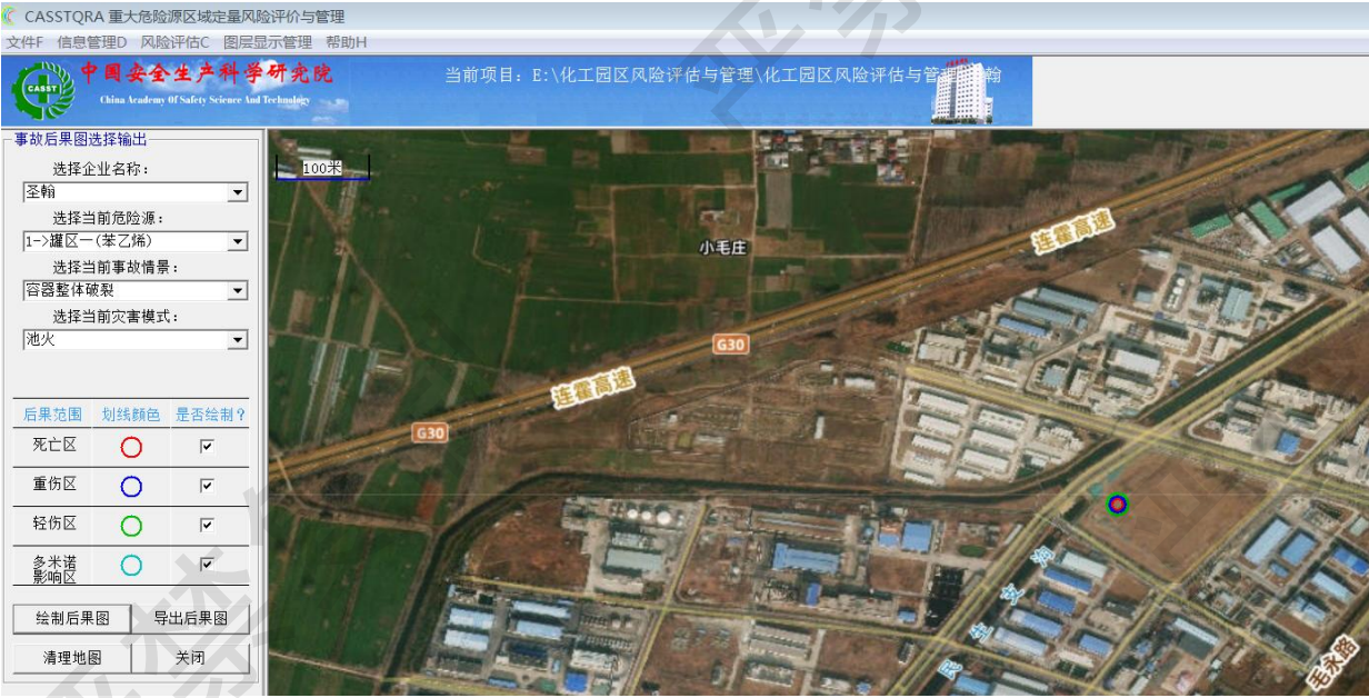
图 7.4 事故后果模拟-苯乙烯储罐完全破裂池火（节选）
