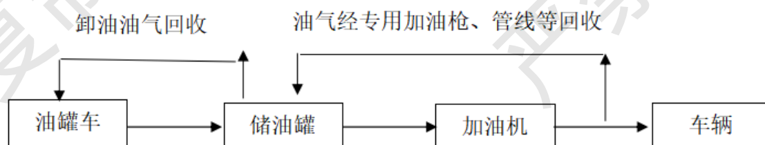
图 2-2 加油站工艺流程图
