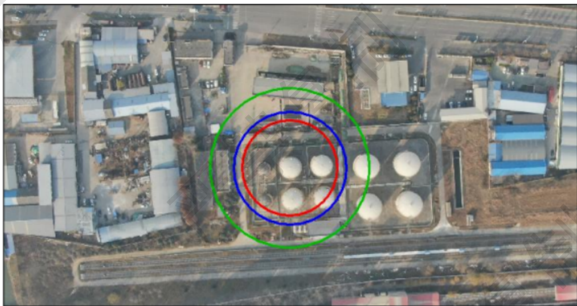
图 2#汽油储罐（容器整体破裂）池火灾事故伤亡范
