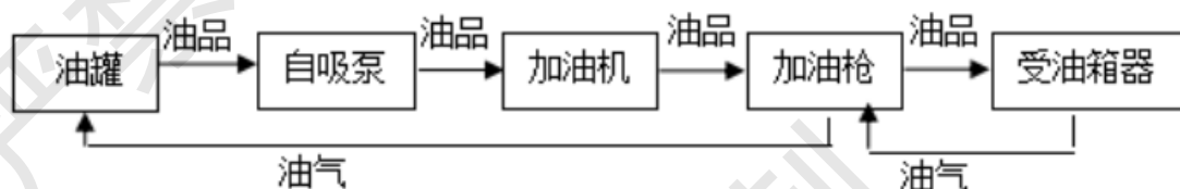
汽油加油工艺流程图
