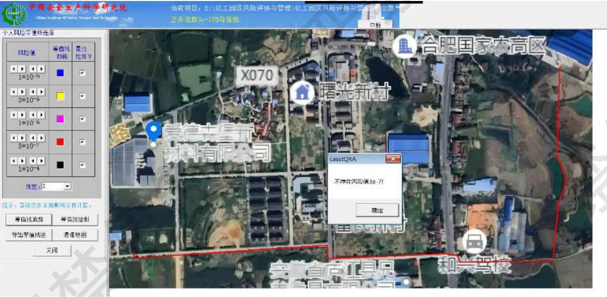
图 7-2 埋地管道个人风险等值线图
