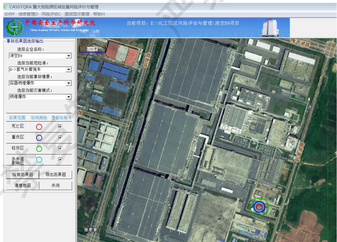
图 5.1 氢气长管拖车容器物理爆炸事故后果模拟图
